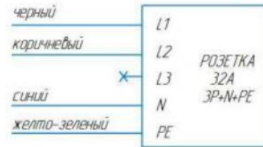
Схема подключения 2ф 380В
